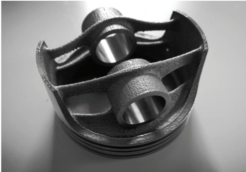
チタンプリンティングによって完成したピストン
